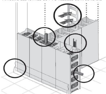
Figura 2 – Amostra das fôrmas de PVC vazadas com concreto
